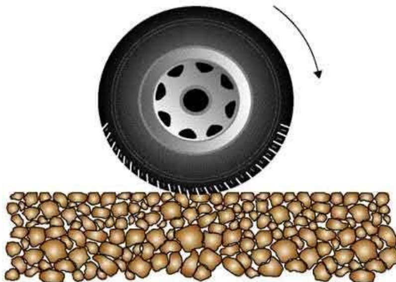
Rysunek 14-4 Asfalt porowaty o dużej zawartości próżni
