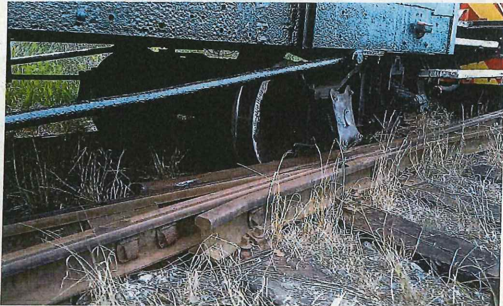
Wózek wykolejonego wagonu po zdarzeniu wymaga napraw – uszkodzone elementy panewki osiowej
