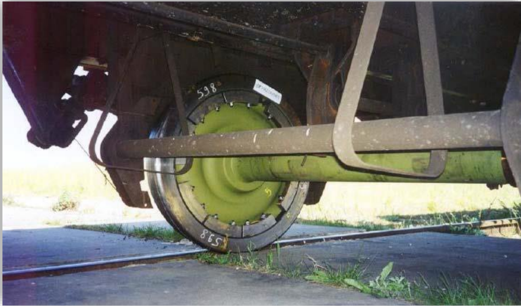
Rysunek 30. Przykładowe zastosowanie amortyzatorów kół (źródło: Hemsworth 2006)
