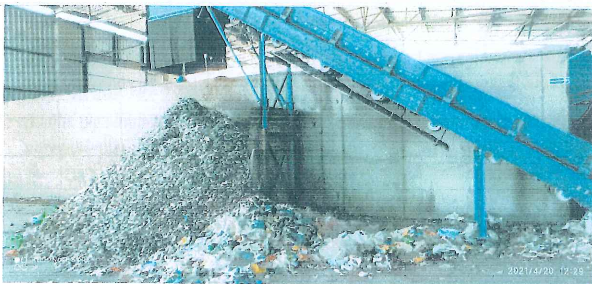
Hala sortownicza nr 2 (produkcja paliwa alternatywnego RDF),
